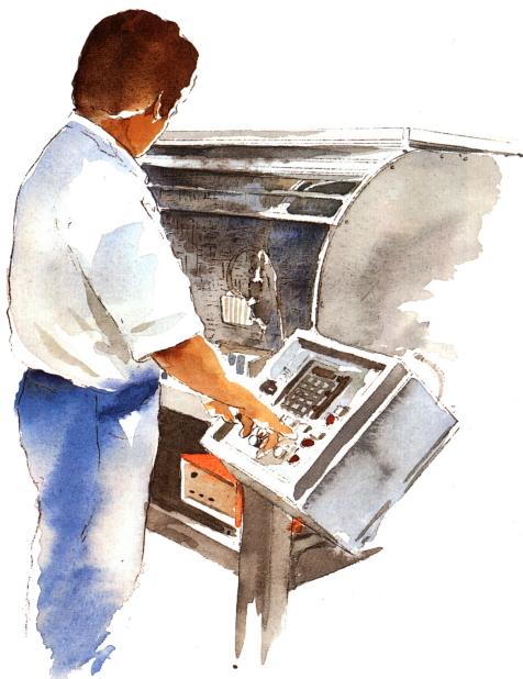
CNC-gesteuerter Kondensatorbolzenautomat. Kapazität 1- 12 mm auf dünnen Blechen, schweißt bis zu 60 Bolzen pro Min.
